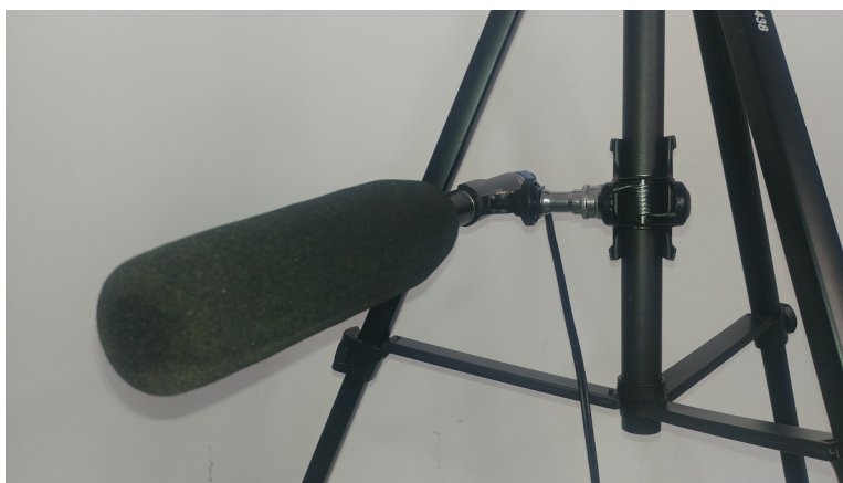
Klips z mikrofonem kierunkowym, przymocowany do kolumny statywu video
