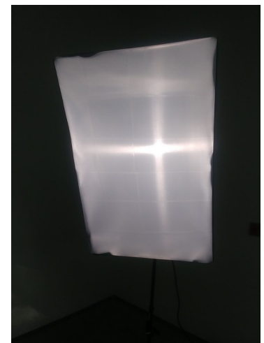
Lampa z nasadką Softbox z zamontowaną blendą dużą
