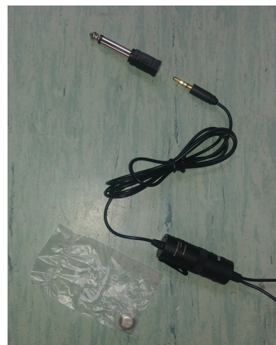
Widoczny fantom mikrofonu wraz z baterią i adapterem jack
